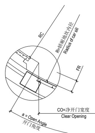
下置式圆弧中分层门-隐框玻璃门板
